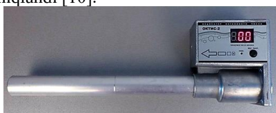
1-súwret. OKTIS-2 benziniń oktan sanın (I.U.) anıqlawshı apparat
